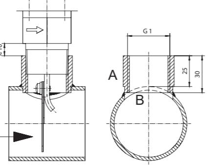
Il raccordo filettato a saldare (A) deve essere montato come in Fig. 2. Porre attenzione che il raccordo non fuoriesca dalla circonferenza interna della tubazione (B).
