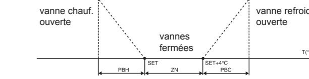
Dans la zone neutre le régulateur est en stand-by, les vannes sont fermées et le ventilateur est immobile.
