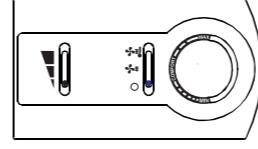
Erster Wählschalter: händisches Einstellen der Ventillergeschwindigkeit.
