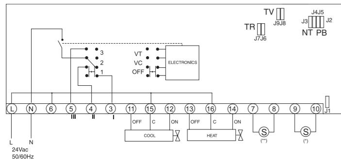
(\*) Sonda esterna (opzionale) / Remote sensor (optional) / Aussenfühler (auf Anfrage) / Sonde à distance (option)
