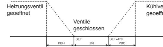
Innerhalb der neutralen Zone steht der Thermostat auf Stand-by, die Ventile werden geschlossen und der Ventilator bleibt ausgeschaltet.
