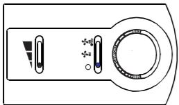
Primo selettore: impostazione manuale della velocità di ventilazione.
