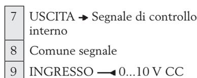
I morsetti 7 e 9 sono collegati in fabbrica mediante ponticello. Rimuovere il ponticello nel caso di utilizzo di segnale di controllo esterno
