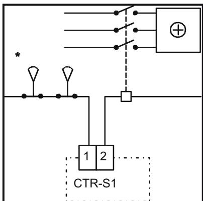
\*Verwenden Sie z. B. Sensor DTV als Lüfterüberwachung.
