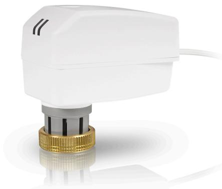
SEZ2 è una gamma di attuatori elettromeccanici per valvole con forza di 200 N, destinati al controllo delle valvole Industrietechnik VFX2/VFX3/VFX4 e VFPI/VFPIP/VFPIIM, (DN15-32 con corsa 2,7 mm/6 mm), nonché per un'ampia gamma di altre valvole sul mercato. Gli attuatori possono essere azionati manualmente con il meccanismo di comando manuale, utilizzando una chiave a brugola, sulla parte superiore.
