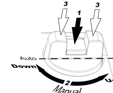
Die Ventilstellung kann manuell eingestellt werden, indem der mittlere Teil des Drehknopfes heruntergedrückt wird, bis er einrastet (1 in der Abbildung). Danach kann die Ventilstellung durch Drehen des Knopfes verstellt werden (2 in der Abbildung). Im Uhrzeigersinn wird die Antriebsstange nach unten, und gegen den Uhrzeigersinn nach oben bewegt.
