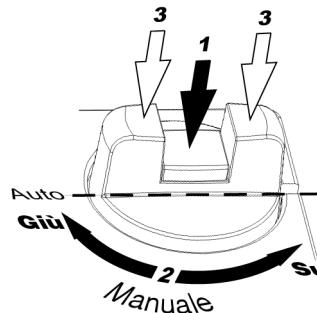
Per impostare manualmente la posizione della valvola, premere prima il centro della manopola finché non viene prodotto uno scatto e il pulsante rimane abbassato (1 in figura). Dopodiché è possibile modificare la posizione della valvola manualmente ruotando la manopola (2 in figura). Ruotando in senso orario, il perno si estende, mentre ruotando in senso antiorario esso si ritrae.
