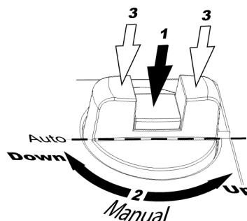
Pour régler manuellement la position de la vanne, appuyez sur la partie centrale du bouton jusqu'à entendre un clic. Elle doit rester enfoncée (n°1 sur le schéma ci-dessus). Il est alors possible de modifier manuellement la position du boisseau en tournant le bouton (n°2 sur le schéma ci-dessus). Tournez dans le sens des aiguilles d'une montre pour faire sortir la tige d'actionnement, ou dans le sens inverse pour la faire rentrer.
