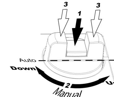
Um die Ventilposition manuell einzustellen, drücken Sie zuerst den mittleren Teil des Knopfs bis er einrastet und gedrückt bleibt (siehe 1 in der Zeichnung). Es werden das Getriebe und die Versorgungsspannung vom Motor weggeschaltet. Danach kann die Ventilposition manuell verändert werden, indem Sie den Knopf drehen (2 in der Zeichnung). Das Drehen im Uhrzeigersinn bewegt die Ventilspindel nach oben. Das Drehen gegen den Uhrzeigersinn bewegt die Ventilspindel nach unten.
