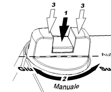
Per impostare manualmente la posizione della valvola, premere prima il centro della manopola finché non viene prodotto uno scatto e il pulsante rimane abbassato (1 in figura). Dopodiché è possibile modificare la posizione della valvola manualmente ruotando la manopola (2 in figura). Ruotando in senso orario, il perno si estende, mentre ruotando in senso antiorario esso si ritrae.
