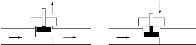
Bild 3 Links: Das Ventil ist geöffnet, wenn die Ventilspindel ausgefahren ist. Rechts: Das Ventil ist geschlossen, wenn die Ventilspindel in das Ventil hineingeschoben ist.
