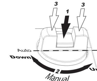
Pour régler manuellement la position de la vanne, appuyez sur la partie centrale du bouton jusqu'à entendre un clic. Elle doit rester enfoncée (n°1 sur le schéma ci-dessus). Il est alors possible de modifier manuellement la position du biseau en tournant le bouton (n°2 sur le schéma ci-dessus). Tournez dans le sens des aiguilles d'une montre pour faire sortir la tige d'actionnement, ou dans le sens inverse pour la faire rentrer.
