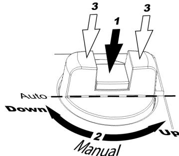
Die Ventilstellung kann manuell eingestellt werden, indem der mittlere Teil des Drehknopfes heruntergedrückt wird, bis er einrastet (1 in der Abbildung). Danach kann die Ventilstellung durch Drehen des Knopfes versteilt werden (2 in der Abbildung). Im Uhrzeigersinn wird die Antriebsstange nach unten, und gegen den Uhrzeigersinn nach oben bewegt.
