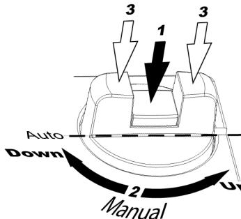
För att manuellt ställa in ventilpositionen, tryck först ned mittknappen på ratten tills den klickar och stannar kvar i nedtryckt läge (1 i figuren). Ventilpositionen kan då ändras manuellt genom att vrida på ratten (2 i figuren). Vid medurs vridning skjuts drivstången utåt och vid moturs vridning dras den inåt.
