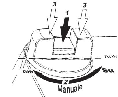
Per impostare manualmente la posizione della valvola, premere prima il centro della manopola finché non si sente uno scatto e il pulsante rimane abbassato (1 in figura). Dopodiché è possibile modificare la posizione della valvola manualmente ruotando la manopola (2 in figura). Ruotando in senso orario, il perno si estende, mentre ruotando in senso antiorario esso si ritrae.
