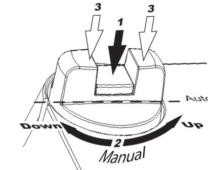
För att manuellt ställa in ventilpositionen, tryck först ned mittenknappen på ratten tills den klickar och stannar kvar i nedtryckt läge (1 i figuren). Detta frikopplar kuggväxeln och bryter även matningsspänningen till motorn. Ventilpositionen kan då ändras manuellt genom att ratten vrider (2 i figuren). Vid medurs vridning skjuts drivstången utåt och vid moturs vridning dras den inåt.
