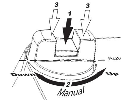
Um die Ventilposition manuell einzustellen, drücken Sie zuerst den mittleren Teil des Knöpfes bis er einrastet und gedrückt bleibt (siehe 1 in der Zeichnung). Es werden das Getriebe und die Versorgungsspannung vom Motor weggeschaltet. Danach kann die Ventilposition manuell verändert werden, indem Sie den Knopf drehen (2 in der Zeichnung). Das Drehen im Uhrzeigersinn bewegt die Ventilspindel nach oben. Das Drehen gegen den Uhrzeigersinn bewegt die Ventilspindel nach unten.
