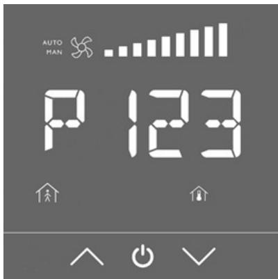
Figure B-1 Display when inside the parameter list
