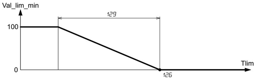
*Val\_lim\_min*: valore teorico dell'uscita di limite minima in raffreddamento
