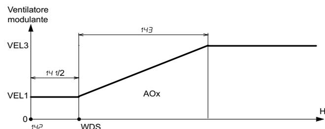
*H: valore dell'umidità rilevata dalla sonda umidità interna o remota*
