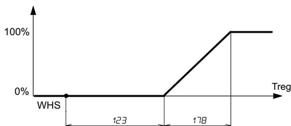
Treg: temperatura di regolazione ambiente/remota se 001=0 o mandata se 001=1 e 019=2 (AI1) o 021=2 (AI2) o 023=2 (AI3) con serranda esterna modulante.
