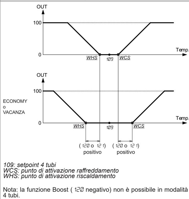
E' possibile visualizzare il setpoint di lavoro impostando il parametro 193 o 194 a 6. In questo caso viene visualizzato in riscaldamento il valore corrispondente a WHS, in raffreddamento il valore corrispondente a WCS.
