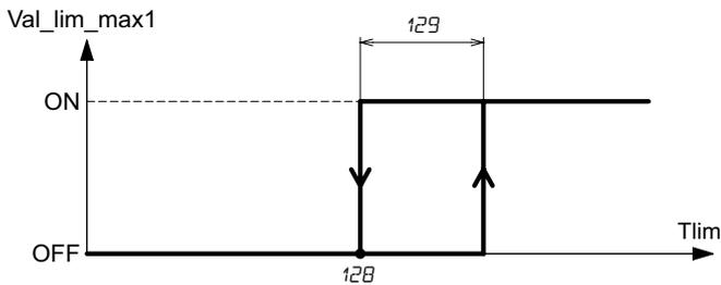
*Val\_lim\_max1: valore teorico dell'uscita di limite massima in riscaldamento Val\_lim\_max convertita in ON/OFF*
