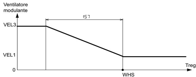
Treg: temperatura della sonda ambiente/remota ( $\text{B33}=0$ ) o della sonda di mandata ( $\text{B33}=1$ )
