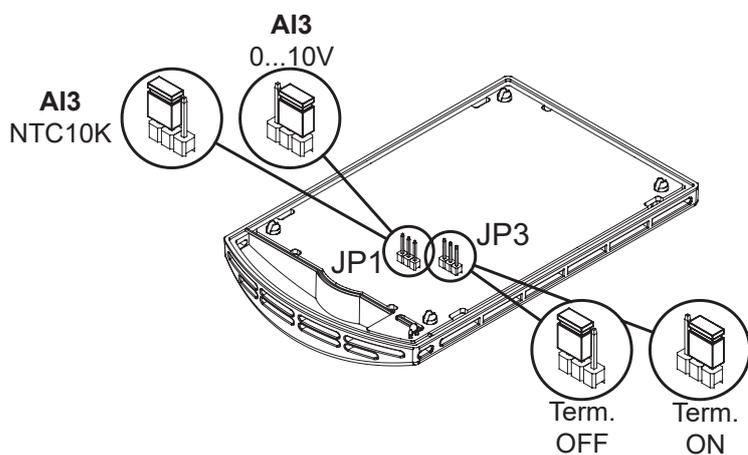
**JP3=Term. ON** → resistenza 120 ohm di terminazione linea Modbus INSERITA (modello **AHU-xMxSx1**).
