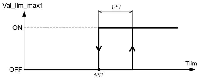
*Val\_lim\_max1*: valore teorico dell'uscita di limite massima in raffreddamento *Val\_lim\_max* convertito in ON/OFF
