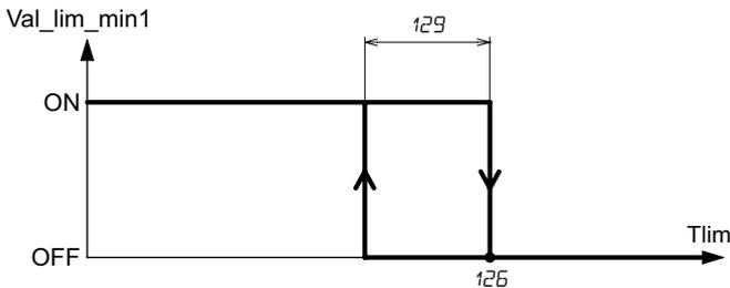
*Val\_lim\_min1*: valore teorico dell'uscita di limite minima in raffreddamento *Val\_lim\_min* convertita in ON/OFF
