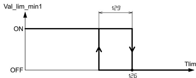
$Val\_lim\_min1$ : valore teorico dell'uscita di limite minima in riscaldamento  $Val\_lim\_min$  convertito in ON/OFF
