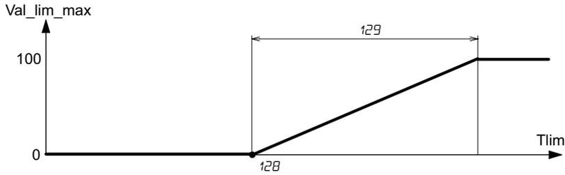
*Val\_lim\_max: valore teorico dell'uscita di limite massima in riscaldamento*
