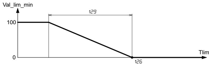
$Val\_lim\_min$ : valore teorico dell'uscita di limite minima in riscaldamento
