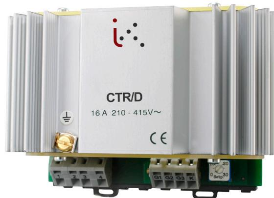
**CTR/D è un regolatore indicato per il controllo proporzionale a tempo di batterie elettriche, pannelli elettrici, ecc. Può essere collegato a tensione monofase o bifase, 210...415 VAC.**
