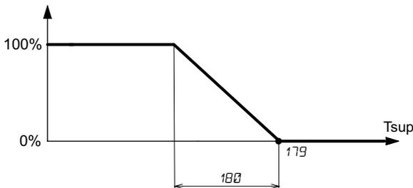
$T_{sup}$ : temperatura di mandata:  $\text{AI1}=2$  (AI1) o  $\text{AI2}=2$  (AI2) o  $\text{AI3}=2$  (AI3)
