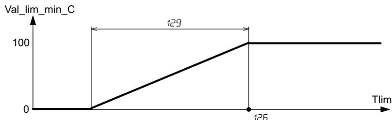
*Val\_lim\_min\_C*: valore teorico dell'uscita di limite minima in raffreddamento
