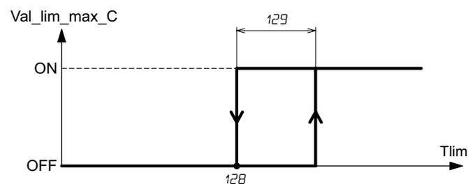
$Val\_lim\_max\_C$ : valore teorico dell'uscita di limite massimo in raffreddamento
