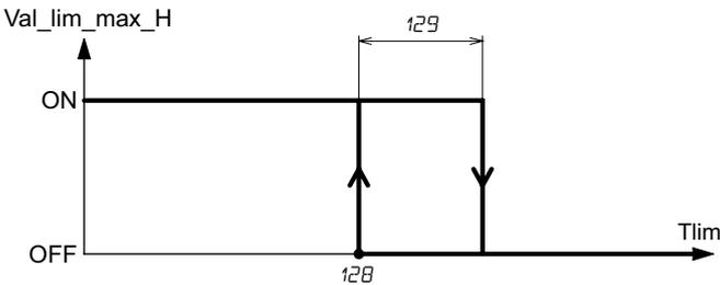
*Val\_lim\_max\_H*: valore teorico dell'uscita di limite massima in riscaldamento
