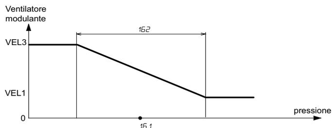
*pressione: pressione differenziale rilevata dal trasmettitore di pressione differenziale*
