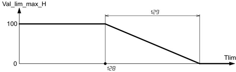
*Val\_lim\_max\_H*: valore teorico dell'uscita di limite massima in riscaldamento
