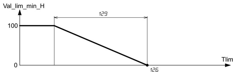
*Val\_lim\_min\_H*: valore teorico dell'uscita di limite minima in riscaldamento
