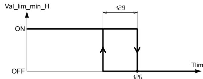
*Val\_lim\_min\_H*: valore teorico dell'uscita di limite minima in riscaldamento
