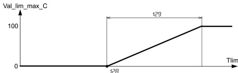
$Val\_lim\_max\_C$ : valore teorico dell'uscita di limite massimo in raffreddamento
