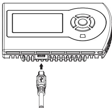
Il collegamento può essere fatto sia con apparecchio sotto tensione, sia senza tensione di alimentazione.
